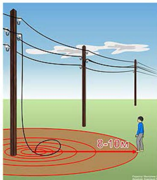
Угрозу жизни представляют не только свисающие или оборванные провода электросетей, но и провода линий радиотелефонной связи, которые могут склестываться с проводами воздушных линий электросетей. Большую опасность представляют провода воздушных линий и ответвлений от них к постройкам, расположенные в кроне деревьев или кустарников. Нельзя раскачивать деревья вблизи линии электропередач. Сыре дерево служит проводником электрического тока.
